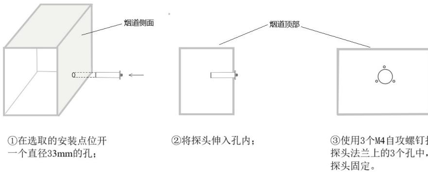
**安装分体式类型的监控仪的探头：**安装前检查探头应完好无损，探头上的各组成部件之间应紧密连接无松动。安装时先在选取的安装点位开一个直径50mm的孔，将探头伸入孔内，然后将探头调整为正方向(使探头排气孔垂直于地面)；然后使用5个M4自攻螺钉打入探头外壳上的5个孔中，将探头固定。然后将探头上的引出线穿过电工套管后从监控仪底部的接入孔接入监控仪内部主控制板上的右/左烟道的接入端子，按照 **6、接线方式** 中的方法接线。
