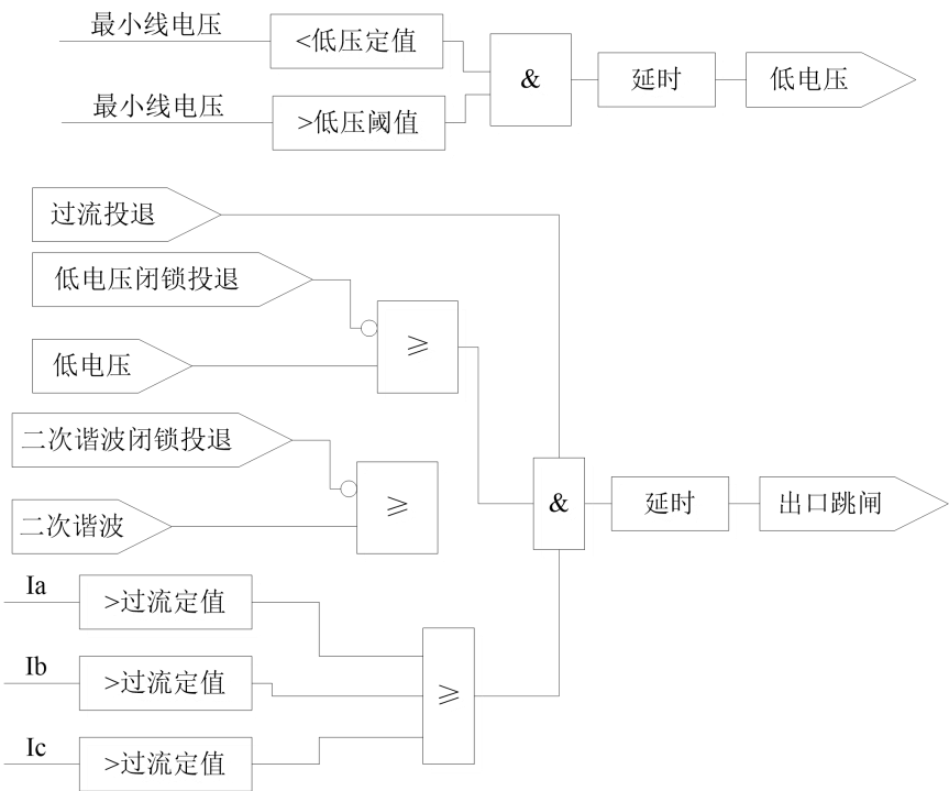
图 1.1 三段式过流保护逻辑
