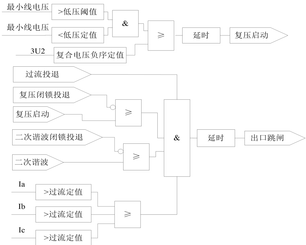
图 2.1 三段式过流保护逻辑
