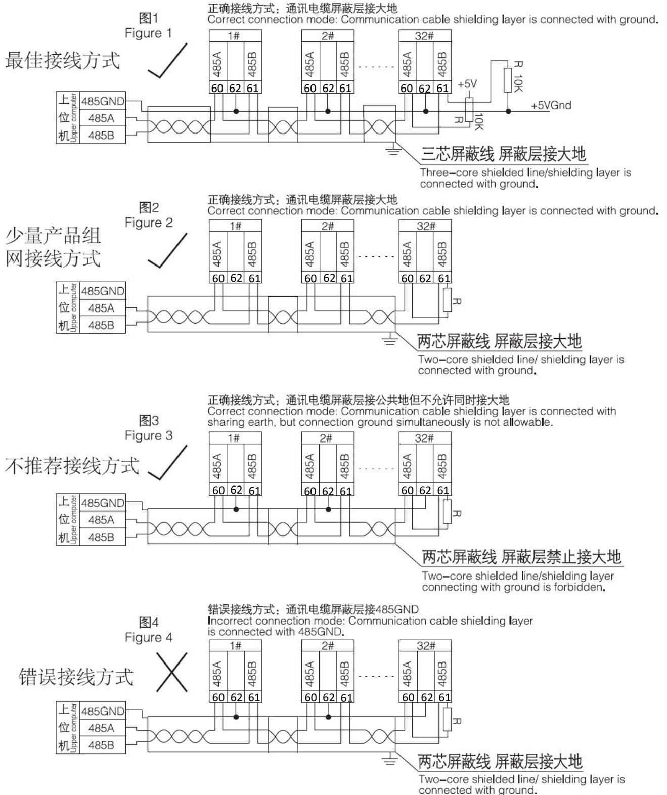
当多个 ARTU 组网使用时，最后一个的 RS485 的 A 和 B 端子上应并接一个终端匹配电阻 R，以保证通讯阻抗匹配，终端匹配电阻一般在  $120\ \Omega$ – $10\text{k}\ \Omega$  之间，布线不同终端匹配电阻可能会不同。上图为使用三芯屏蔽线的示意图，屏蔽层接大地，各个设备的 G1 端子并接。
