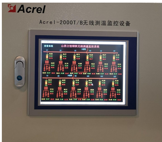
图 1.4 Acrel-2000T/B 无线测温监控设备实物图
